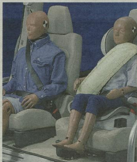
La simulazione Un test sui manichini. L'airbag nelle cinture era apparso come progetto avveniristico nel 2001 a Detroit
